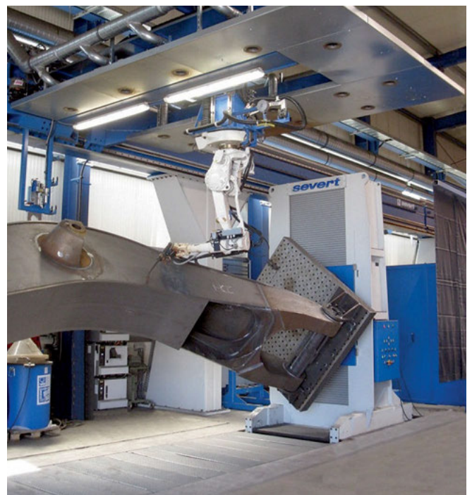
Bild 6: Absaughaube über Schweißroboter
