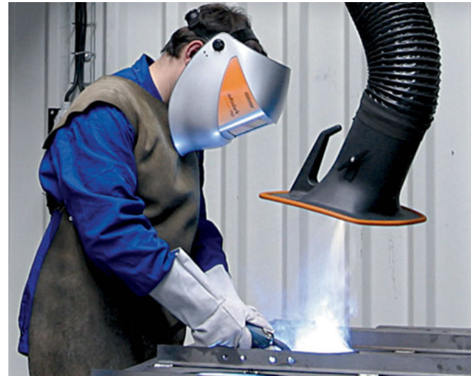
Bild 5: Absaughaube einer Niedrigvakuum- Punktabsaugung
