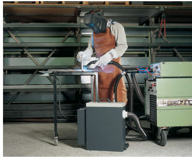
Bild 3: Schweißbrenner mit integrierter Absaugdüse
