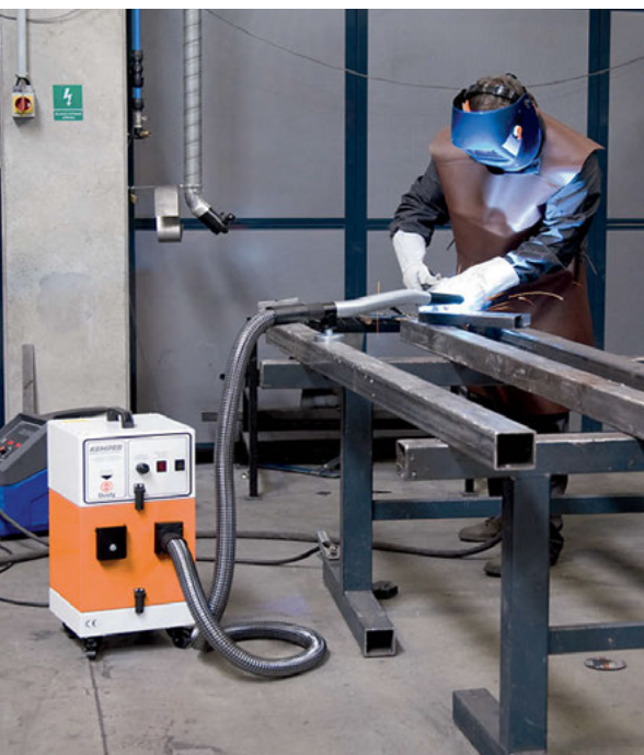
Bild 4: Hochvakuum-Punktabsaugung Quelle: KEMPER GmbH
